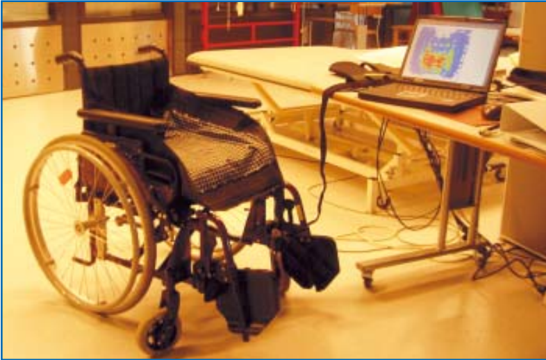
Pyörätuolissa paineanturimatto, joka on yhdistetty tietokoneeseen
